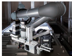
活用工業機械手臂下方有限空間的自製SCARA機器人
