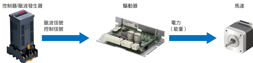
圖 1.2 步進馬達的運轉系統
