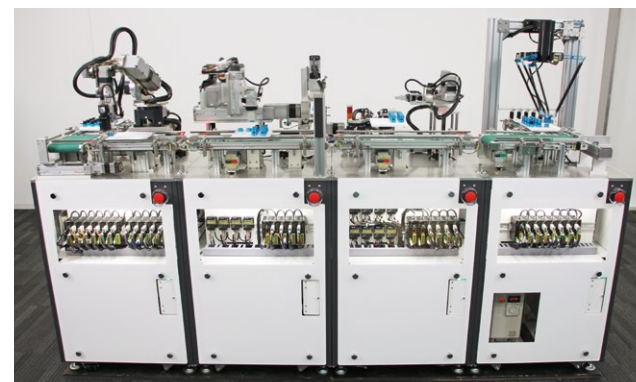
左起為「工件投入和排列」、「工件組裝和壓裝」、「工件外觀檢查」、「工件分解」Demo機
