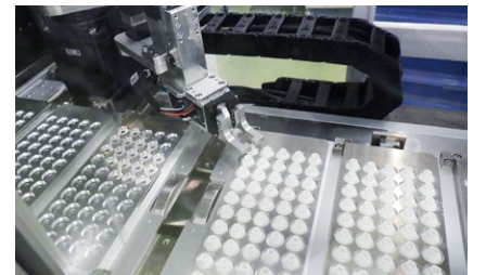
運用SCARA機器人拾取小型零件 控制夾爪的電流值，以不損傷零件的力度抓取
