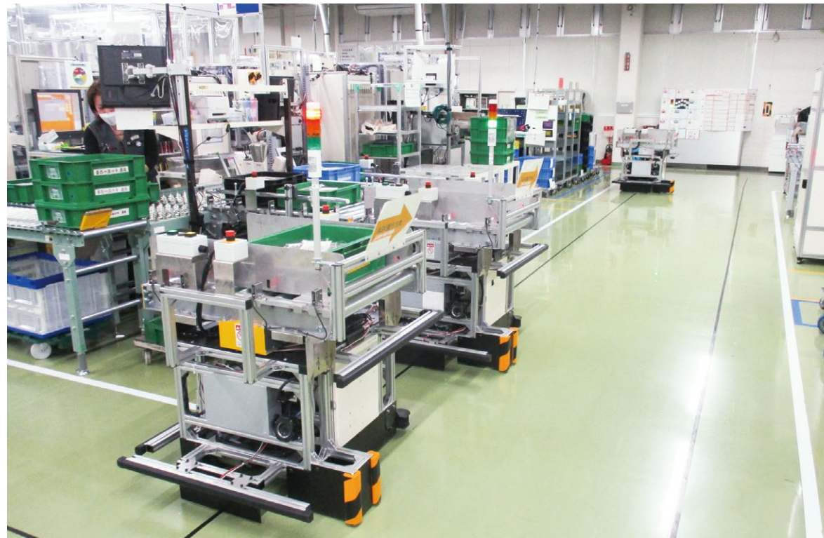
運用串聯生產工序的AGV，使工件搬運自動化
