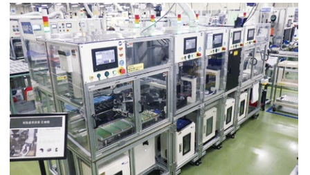
由SCARA機器人負責黏著作業的自動化生產線 對設備的外觀亦很講究，例如採用透明的正面面板等，方便觀察機器人動作
