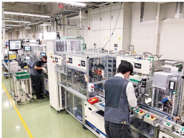
自動化與人員技能相結合的馬達裝配生產線
