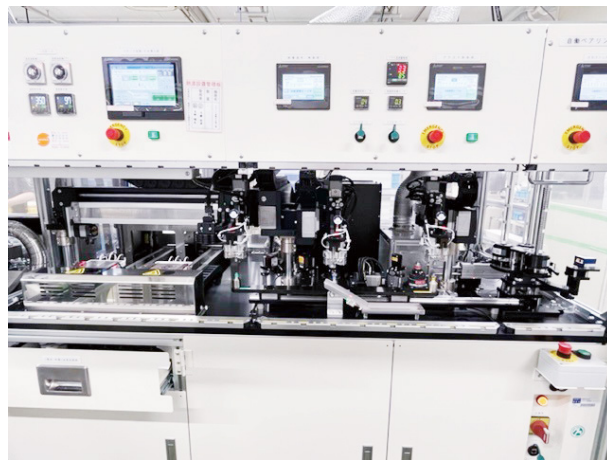
滾珠軸承粘合自動化生產線
